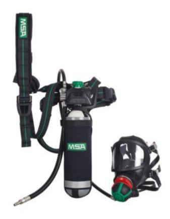
Die PremAire Combination, eine vielseitige, komfortable und erschwingliche Schlauchflucht-Geräte Kombination mit Druckluftflasche. Die schlanke Konstruktion integriert die erste Druckminderer-Stufe und das Flaschenventil in einer Baugruppe, wodurch Größe und überstehende Teile stark reduziert werden, und damit auch die Gefahr des Hängenbleibens beim Arbeiten in engen Räumen.
